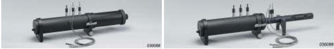
Şekil 1. Ses yutma katsayısının frekansa bağlı olarak belirlenmesi amacıyla kullanılan ölçüm sistemi.
